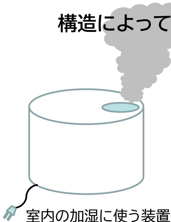
電気ヒーター(電極式を含む)により湯を沸かして加湿するもの
