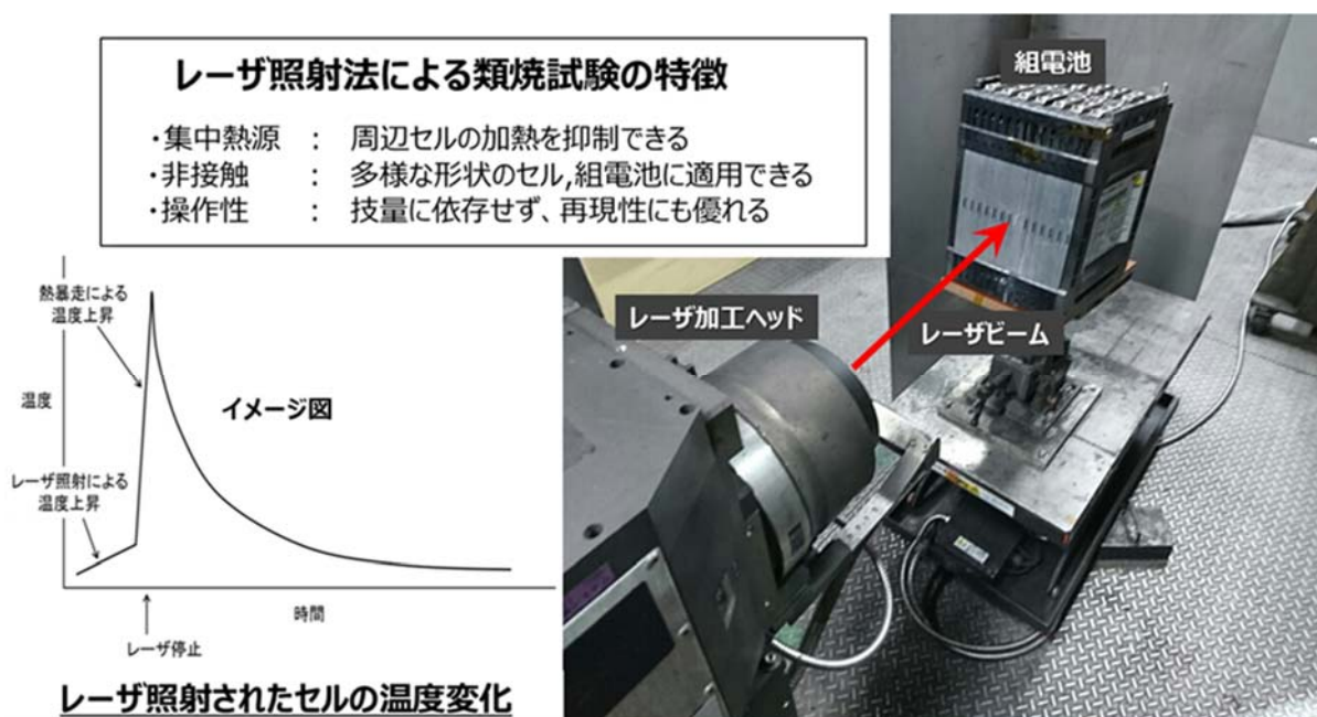
図1 レーザー照射法による類焼試験
