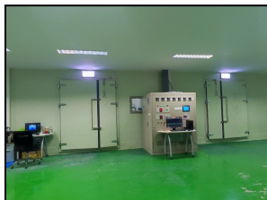
写真②： カロリーメーター付き恒温 恒湿槽（6万BTU）
