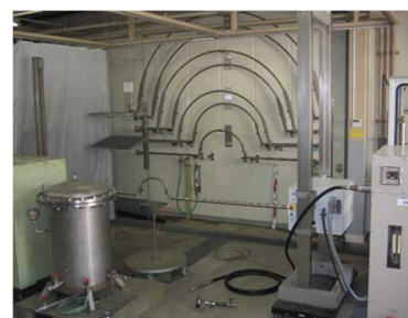
アーチシャワー試験装置
