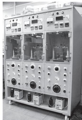
電極間隔（4mm）調節ツマミの追加や、滴下検出用指針（誤動作防止用）の追加などによって、より正確な試験が可能となっております。また、IEC60112、JIS C 2134の最新規格に対応しております。
