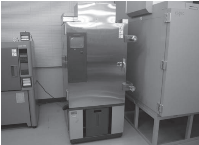
ヒートサイクル試験設備
