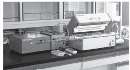
電気ケーブル材料の燃焼時におけるpH及び導電率による発生ガスの酸性度測定) : 燃焼時発生ガスの酸性度の測定 (ハロゲン材料が含まれないことの確認)
