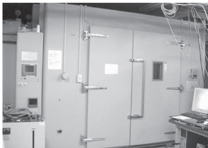
恒温槽使用による環境温度、「高温・低温」のサイクル通電試験
