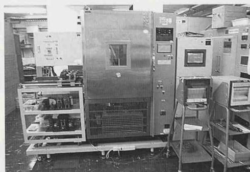
写真上：機器用スイッチ開閉試験装置(高温、低温対応型)
