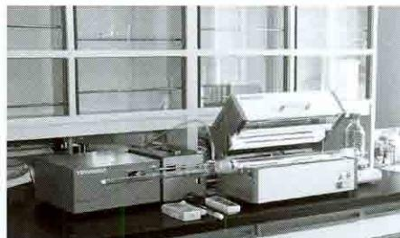
②燃焼時発生ガスの酸性度測定装置
