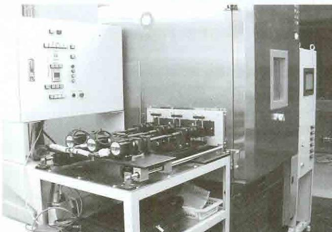
恒温槽を備えた開閉試験機部
