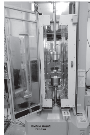
恒温槽に治具を通した状態(扉開放時)
