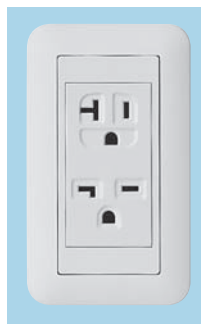
写真7 単相3線配線によりひとつのコンセントから100Vと200Vの電源がとれる。
