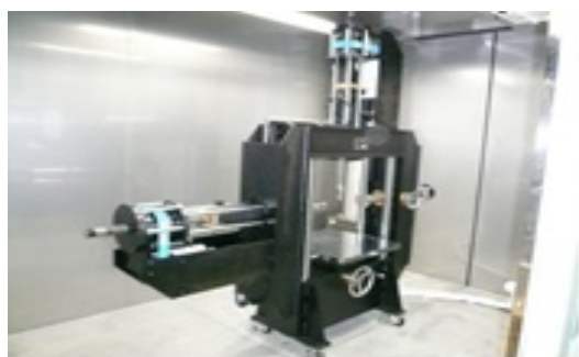
熱暴走を強制的に発生させる釘刺し試験装置
