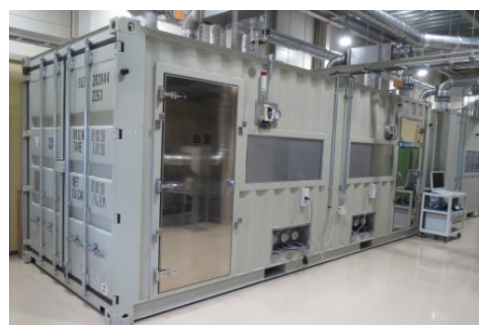
単電池の熱暴走シミュレーションを行うアビュースチャンバ
